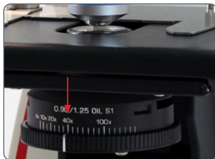
使用物镜放大时对齐旋转环的线。
